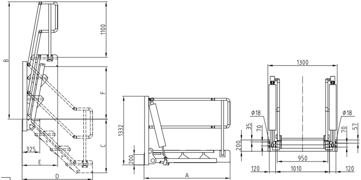
Befestigung: 8 x M16 Festigkeit: 10.9 (für KTC800 bis KTC1600 kann auch 8.8 verwendet werden)
